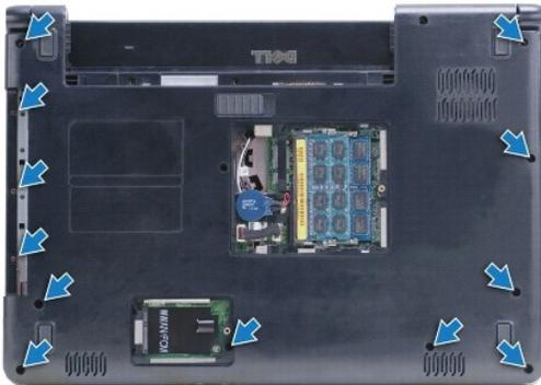
如果是 Inspiron 1570，请拧下计算机底座上的十三颗螺钉。有三颗螺钉位于光盘驱动器托架中。
